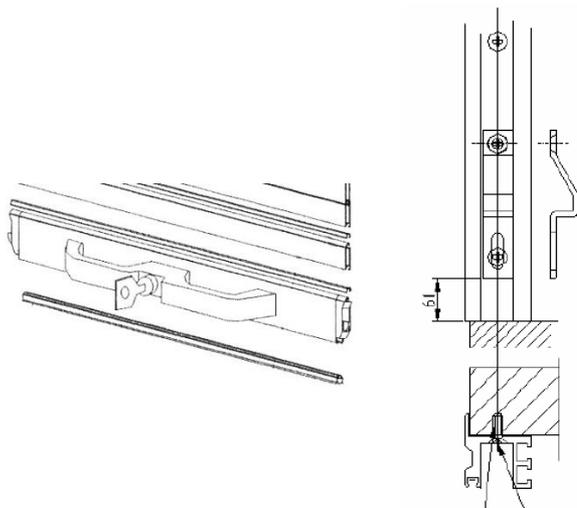
18: Enfiler la barre dans les supports situés dans la partie inférieure du support
