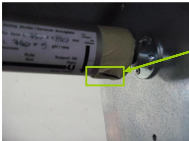
11: Placer maintenant le rouleau sur les supports des plaques de fixation avec marquage au feutre vers le sol
